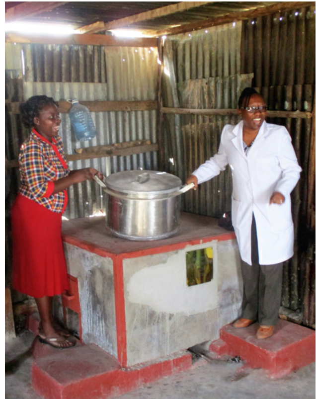
Dieser moderne Schulofen spart im Jahr 50% des benötigten Feuerholzes.
